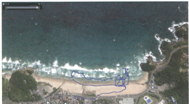
GPS(全地球測位システム)被験者による海浜流の計測結果の例 / 海水の流れや波の状況を知ることで自然のメカニズムを学ぶ。特に、溺水事故の主要因である離岸流(海岸の波打ち際から沖合に向かって生まれる潮流)を計測する。
